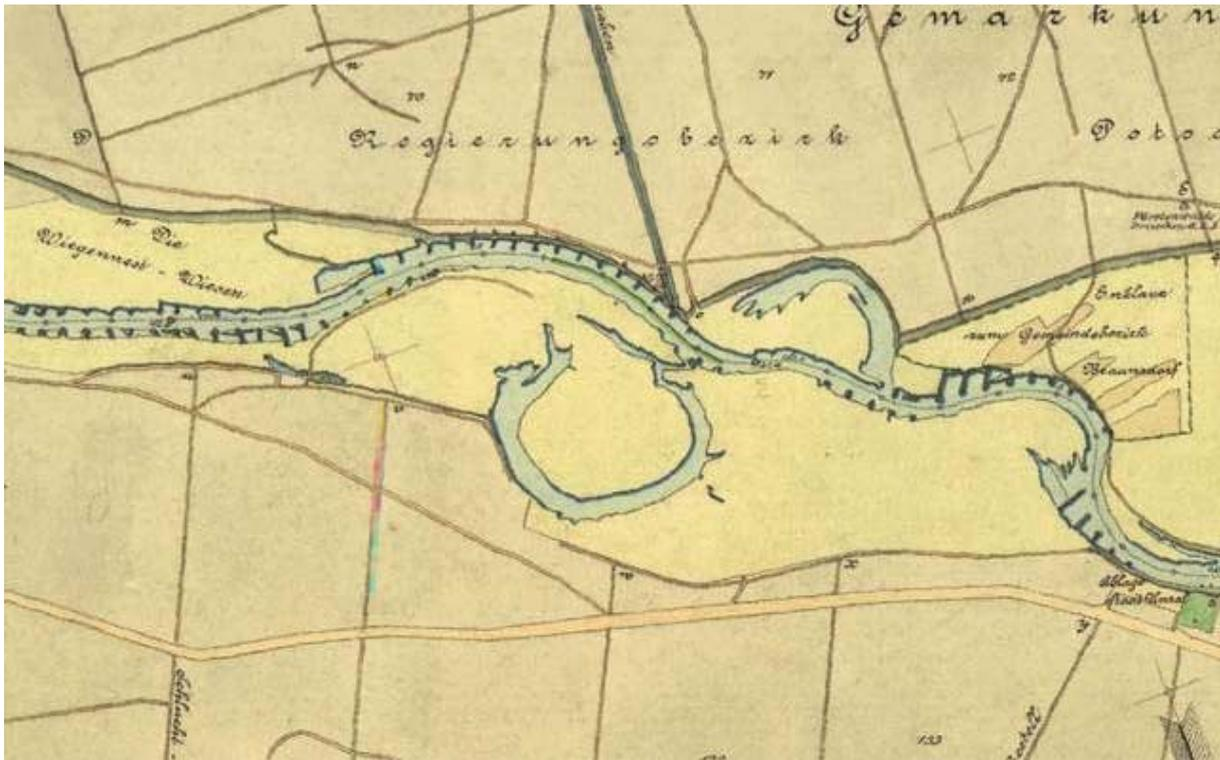
**Abbildung 3:** Kartendarstellung der Uferverbauung der Müggelspree oberhalb Hangelsberg mit Buhnen, die heute noch weitgehend erhalten sind (Auszug aus dem Kartenwerk Müggelspree der Wasserbaudirektion Kurmark von 1921)
